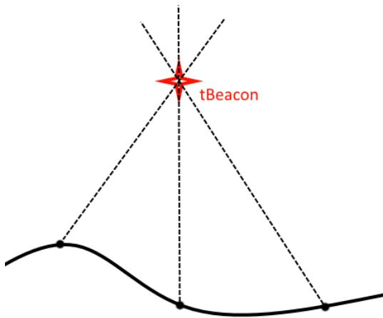
Трехтоновый сигнал, который выдает маяк состоит из тонов разной мощности (первый 100 мВт, второй 13 мВт, третий 1.3 мВт). Экранируя рацию телом, или используя направленную антенну, нужно найти направление, с которого принимается наиболее сильный сигнал. Далее, необходимо либо просто двигаться в направлении сигнала, либо взяв несколько пеленгов, построить на карте линии направлений и двигаться в точку их пересечения.
