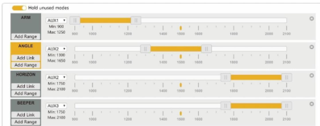
Тумблеры DJI состоят из трех секций. Если переместить желтый курсор соответствующего вспомогательного канала переключателя, то при переходе в заданный диапазон будет включена соответствующая функция.
