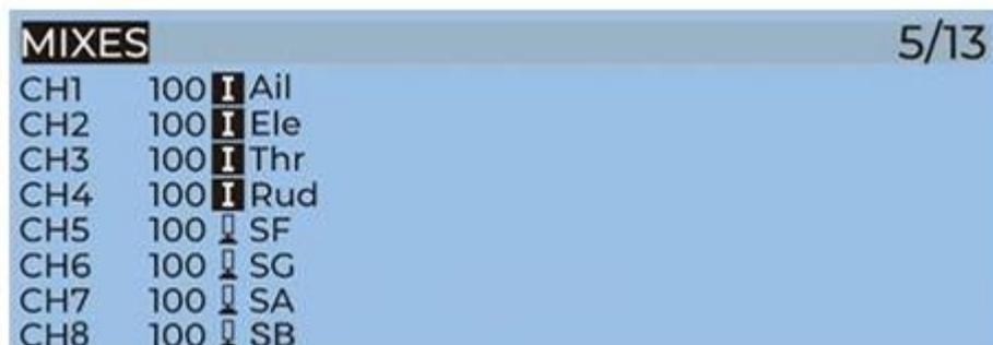
Тумблер SF передатчика FrSky X9D состоит из двух секций. Если переместить желтый курсор соответствующего канала с помощью переключателя, то при переходе в заданный диапазон будет включена соответствующая функция.
