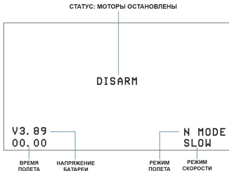
Статус полета квадрокоптера отображается в центре. Статус DISARM означает, что моторы дрона не активны. LOW (НИЗКИЙ) уровень напряжения указывает на низкое напряжение батареи квадрокоптера. LOST RX - (ПОТЕРЯ RX) указывает на то, что квадрокоптер был отсоединен от пульта дистанционного управления;
