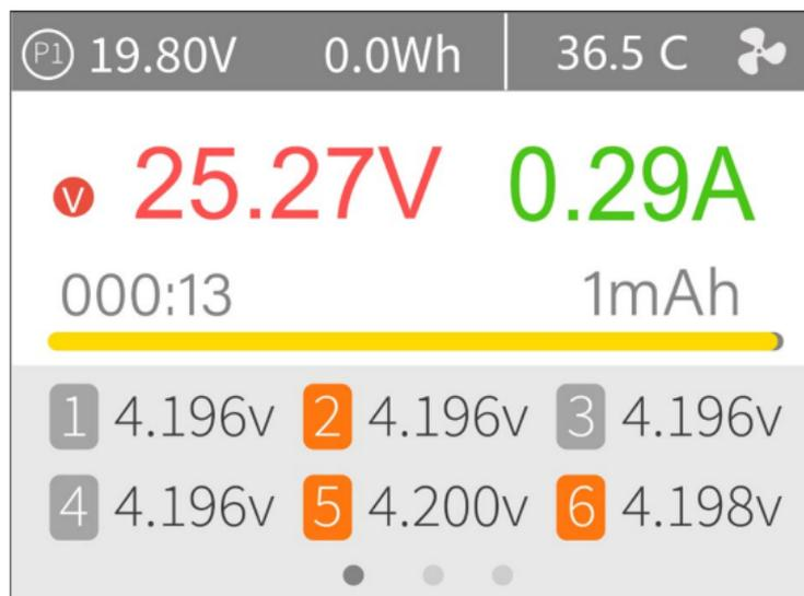
Прокрутите [Колесо Прокрутки] на этом экране, чтобы переключить отображение общей информации, значений внутреннего сопротивления и напряжения. Кратковременное нажатие кнопки [OK] позволяет динамически задавать рабочий ток или остановить работу устройства, как показано ниже:
