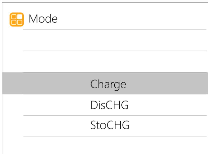
Для **Lipo, LiHV, LiFe, Lion** аккумуляторов доступны режимы зарядки, разрядки и перевода в режим хранения. Для **NiMH** аккумуляторов доступна зарядка, разрядка и циклирование. **PB** аккумулятор можно заряжать и разряжать. Кратковременно нажмите [OK], а затем [Выход], чтобы применить изменения и вернуться к предыдущему интерфейсу.
