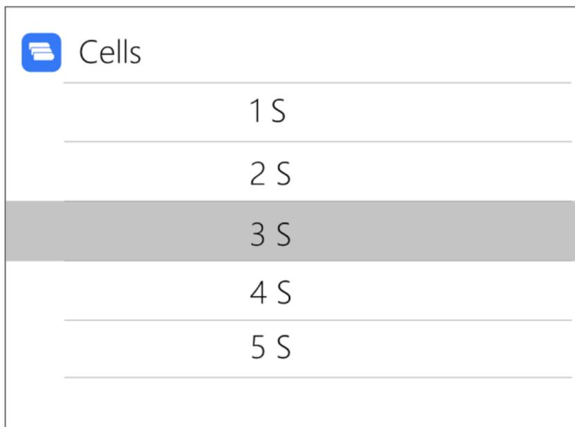
Прокрутите [Колесо Прокрутки], чтобы отрегулировать значение. При установке на **"Auto"** зарядное устройство автоматически распознает количество ячеек. Кратковременно нажмите [OK], а затем [Выход], чтобы применить изменения и вернуться к предыдущему интерфейсу.
