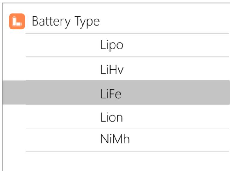
Зарядное устройство поддерживает зарядку и разрядку 6 типов аккумуляторов: **LiPo**, **LiHV**, **LiFe**, **Lion**, **NiMH** и **PB**. Можно также выбрать умный аккумулятор. Выберите тип аккумулятора, соответствующий фактическому. Кратковременно нажмите [OK], а затем [Выход], чтобы применить изменения и вернуться к предыдущему интерфейсу.
